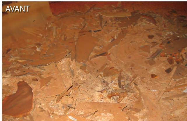
De plus, les imperfections de ces revêtements ainsi que les contraintes liées à la mise en oeuvre, au stockage, au transport et à la dilatation par chauffage peuvent favoriser le contact local de l'eau et des parois internes.
